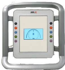
Obrázek 5: Ovládací panel stojanu s rentgenkou se zobrazením úhlu rentgenky
