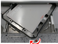
Figure 65 : Exemple : faites pivoter dans le sens horaire pour passer de la position Portrait à la position Paysage
