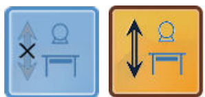
Figure 8 : Activation et désactivation du suivi de la position de la table
