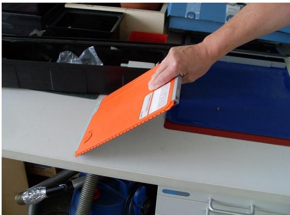
8. Установите верхнюю крышку на сторону кассеты, направляемую к трубке. Убедитесь в том, что направляющие стороны кассеты, направляемой к трубке, надлежащим образом надеты на верхнюю крышку.
