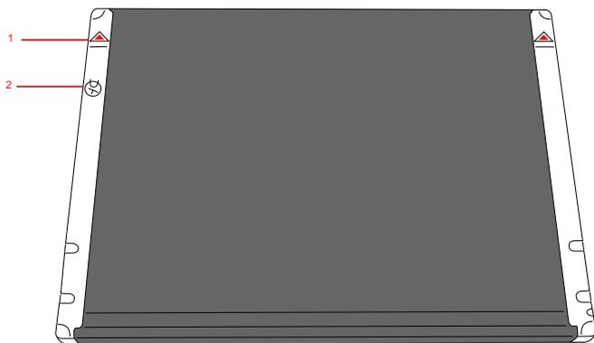
1. Marcador rojo de orientación del chasis que apunta hacia el lado de la pared torácica
