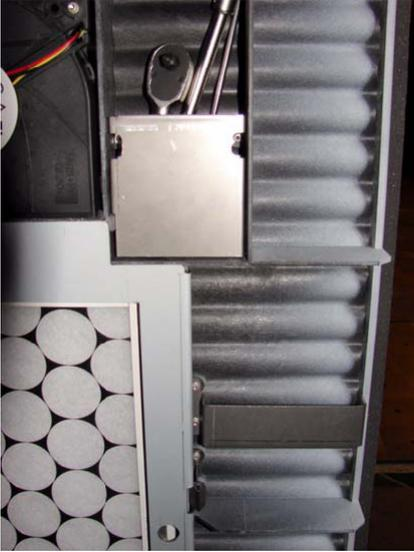
8. Setzen Sie das Werkzeug in die Öffnung ein und drehen die Schraube gegen den Uhrzeigersinn, bis der Digitizer um circa 1,5 bis 2 cm angehoben ist und Sie einen Widerstand spüren.
