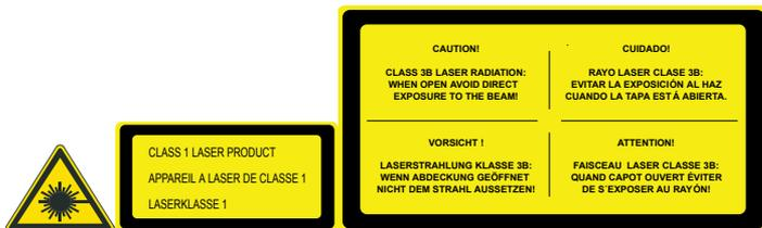
Der Digitizer ist ein Laserprodukt der Klasse 1. Im Gerät kommt eine Laserdiode mit 80 mW der Klassifizierungsklasse IIIB, Wellenlänge 640–670 nm, zum Einsatz. Die Ablenkfrequenz des Laserstrahls beträgt 80 1/s bis zu 170 1/s. Die Laserstrahldivergenz beträgt 12 mrad.
