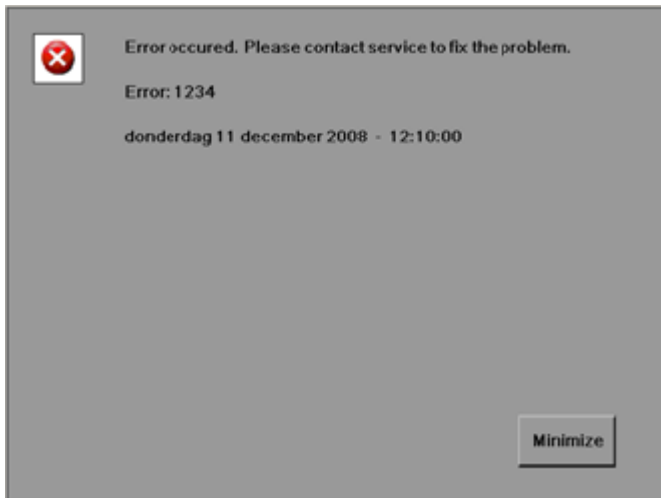
Rysunek 7: Przykład błędu krytycznego (kontrolka statusu świeci ciąglem, czerwonym światłem)
