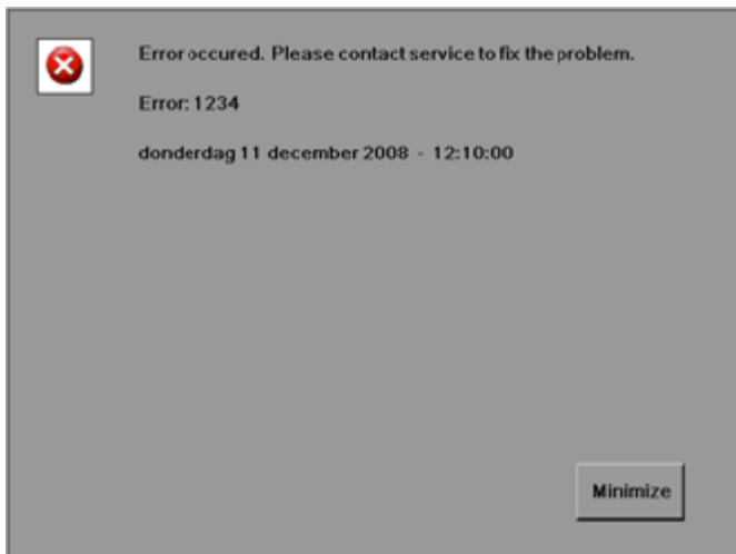
Εικόνα 7: Παράδειγμα μη επανορθώσιμου σφάλματος (ένδειξη κατάστασης συνεχώς κόκκινη)
