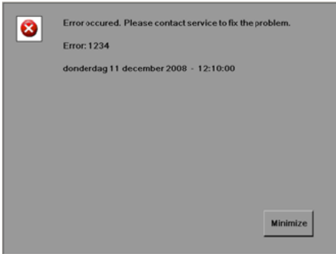
Figur 7: Eksempel på kritisk feil (statuslampen lyser kontinuerlig rødt)
