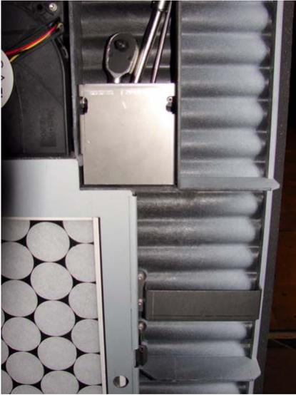
8. Insérez l'outil dans l'ouverture et tournez la vis dans le sens inverse des aiguilles d'une montre, jusqu'à ce que le numériseur se soulève d'environ 1,5 à 2 cm et que vous rencontriez une résistance.
