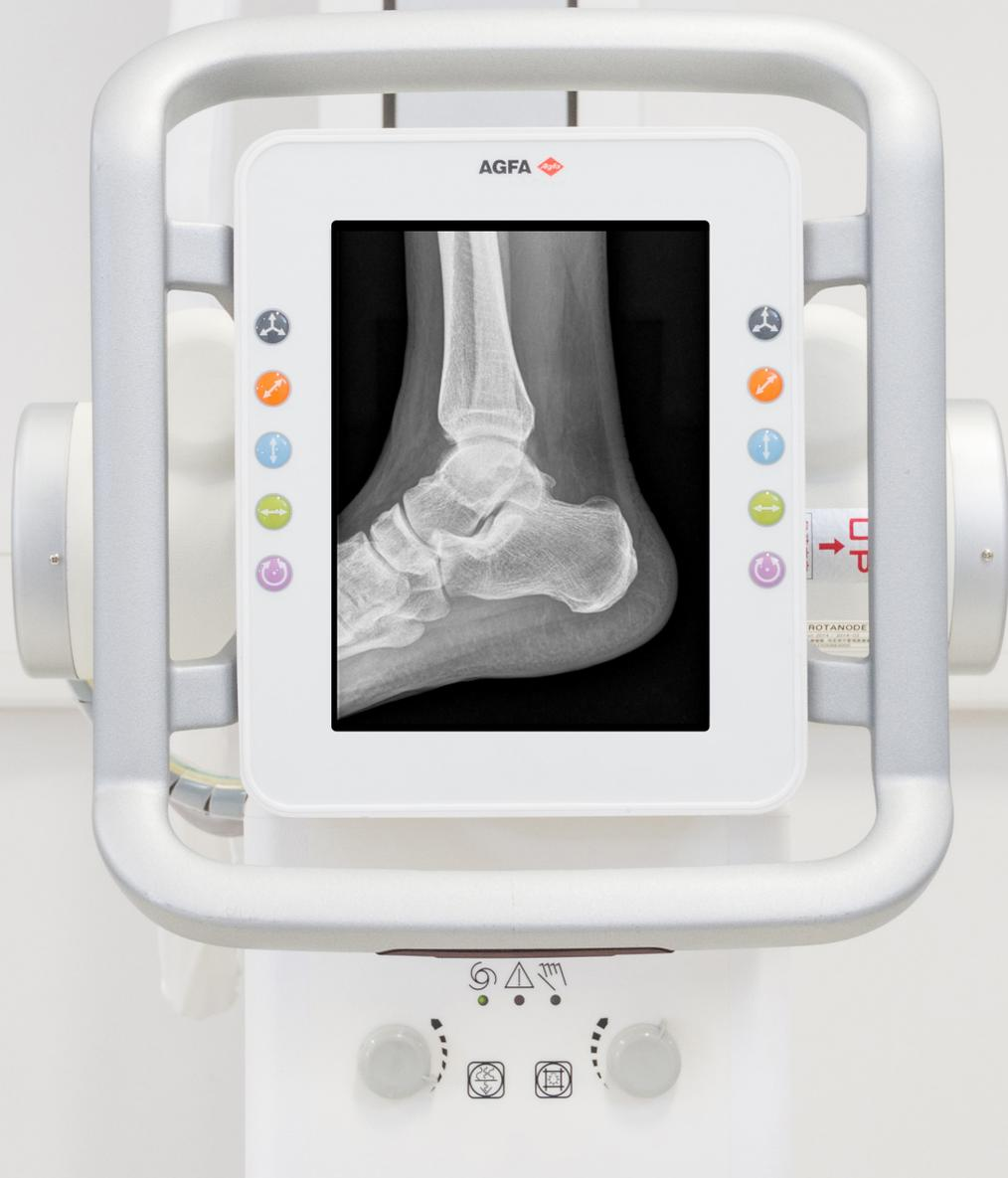
En la pantalla del cabezal del tubo (opcional) se puede visualizar una vista previa de la imagen adquirida.
