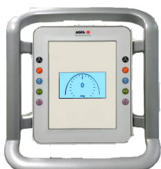
Figure 5 : Panneau de commandes du support du tube à rayons X avec affichage de l'angle du tube à rayons X
