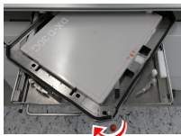
Figura 56: Ejemplo: hágalo girar en sentido horario para cambiar de la posición vertical a la posición horizontal
