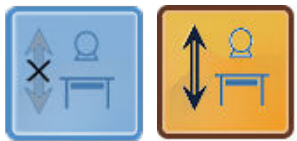
Figura 33: Seguimiento de posición de la mesa radiográfica activado y desactivado
