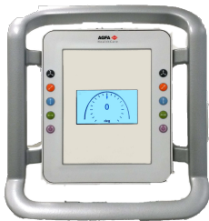
Abbildung 5: Bedienelemente des Röntgenröhrenstativs mit Anzeige des Röntgenröhrenwinkels
