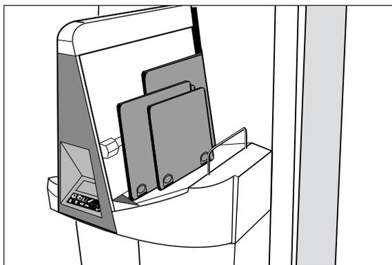
El Digitizer introduce automáticamente el primer chasis, lee la placa de imagen, reenvía los datos digitales de la imagen a la estación de previsualización para una comprobación preliminar rápida y, a continuación, a la estación de procesamiento de imágenes.
