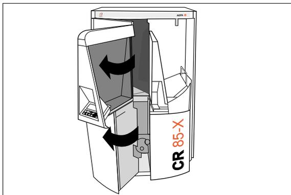
**4** Levante el perno de la puerta inferior y abra la puerta frontal derecha.
