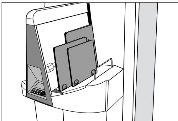
Il Digitalizzatore accetta automaticamente la prima cassetta, legge la lastra ed invia i dati dell'immagine digitale alla stazione di visualizzazione in anteprima per un rapido controllo preventivo ed alla stazione di trattamento immagini per l'elaborazione delle immagini.
