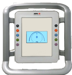
Rysunek 5: Panel sterowania stojaka lampy RTG z wyświetlaczem kąta lampy RTG
