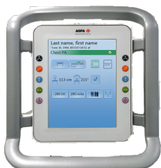
Rysunek 4: Panel sterowania dla stojaka lampy RTG z wyświetlaczem głowicy lampy (sterowanie pozycją lampy RTG i parametrami ekspozycji RTG)
