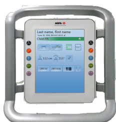
Figura 4: Pannello dei comandi del supporto del tubo a raggi X con visualizzatore della testa del tubo (comandi per la posizione del tubo a raggi X e per i parametri di esposizione ai raggi X)
