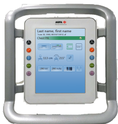
4. Ábra: A röntgenső-állvány vezérlőpultja röntgensőfej kijelzővel (a röntgenső pozíciójának és a röntgen expozíciós paraméterek ellenőrzéséhez)
