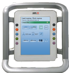
Figura 4: Panel de controlo do suporte do tubo de raios-X com visor da cabeça do tubo (comandos para a posição do tubo de raios-X e para parâmetros de exposição de raios-X)
