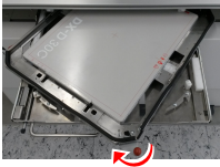
Abbildung 48: Beispiel: Im Uhrzeigersinn drehen, um von der Hochformat- zur Querformatposition zu wechseln.
