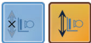
Abbildung 40: Wall Stand-Positionsnachlaufsteuerung deaktiviert und aktiviert
