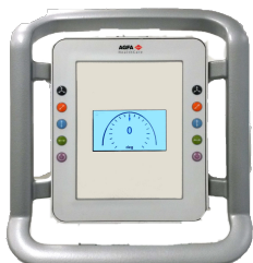
Afbeelding 5: Bedieningspaneel van de röntgenbuisstand met hoekweergave röntgenbuis
