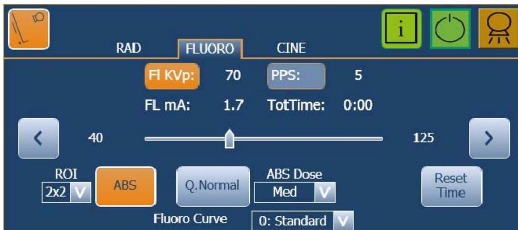
**DURCHLEUCHTUNGS-kVp ERHÖHEN/VERRINGERN:** Hierbei wird die Röntgenröhrenspannung manuell (nicht als ABS) ausgewählt. Der kVp-Wert der Durchleuchtung wird durch Auswahl der Anzeige „Fl kVp“ (die dann hervorgehoben ist) und Änderung des Werts mit den Schaltflächen „Erhöhen“ bzw. „Verringern“ erhöht bzw. verringert.
