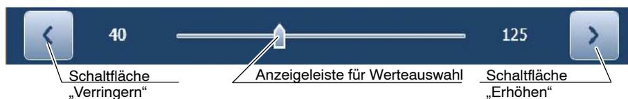
Außer bei den Durchleuchtungsuntersuchungen kann der kVp-Wert der Durchleuchtung auch direkt durch Antippen seiner Stelle auf der Leiste ausgewählt werden. Wenn der Zeiger auf einen nicht erlaubten Wert gestellt wird, kehrt er wieder auf seine vorherige Position zurück und der Parameterwert bleibt unverändert.
