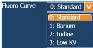
**DURCHLEUCHTUNGSKENNLINIEN:** Diese Funktion steht zur Verfügung, wenn ABS gewählt wurde. Sie verändert die Balance zwischen kV und mA, um die Durchleuchtung oder den Kontrast zu erhöhen.
