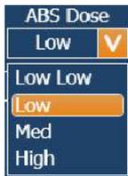
Una vez que se selecciona “Quality Normal”, la Dosis por Cuadro se puede ajustar a Low-Low (Baja-Baja), Low (Baja), Medium (Media) o High (Alta), según la calidad de imagen que necesite el operador.
