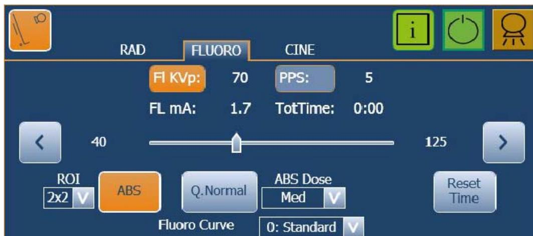
**INCREMENTO / DECREMENTO DE kVp DE FLUORO:** Selecciona la tensión del Tubo de Rayos-X en modo Manual (no modo ABS). El valor de los kVp de Fluoro se incrementan o decrementan seleccionando el Display “Fluoro kVp” (que aparecerá resaltado) y cambiando el valor con los botones de “Incremento” y “Decremento”.
