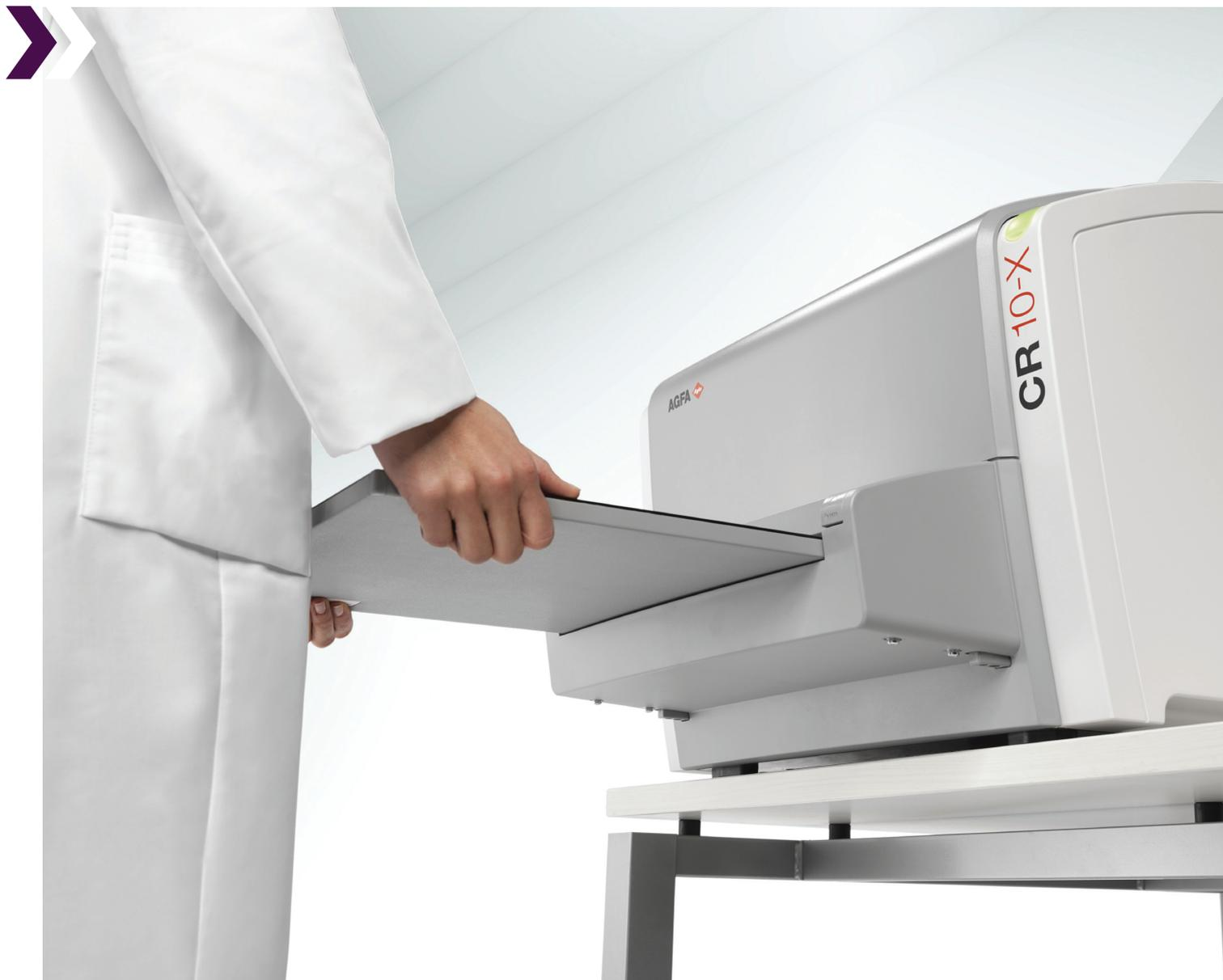
Il design semplice del CR 10-X semplifica e velocizza l'installazione. L'inserimento orizzontale della cassetta impedisce alla polvere e allo sporco di penetrare nel sistema.
