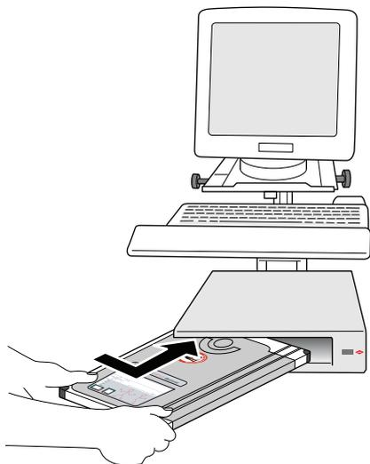
Abbildung 9: Einlegen einer Kassette in das ID Tablet
