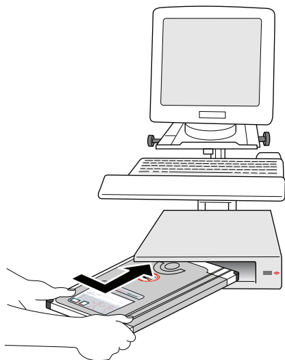
Рисунок 9: Вставка кассеты в идентифицирующий планшет ID Tablet
