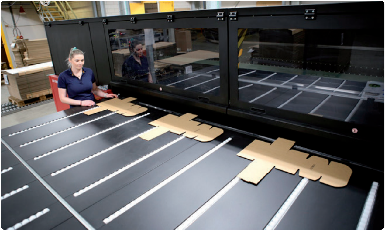
De sterke vacuümtafel is een voordeel bij het printen van golfkarton.
