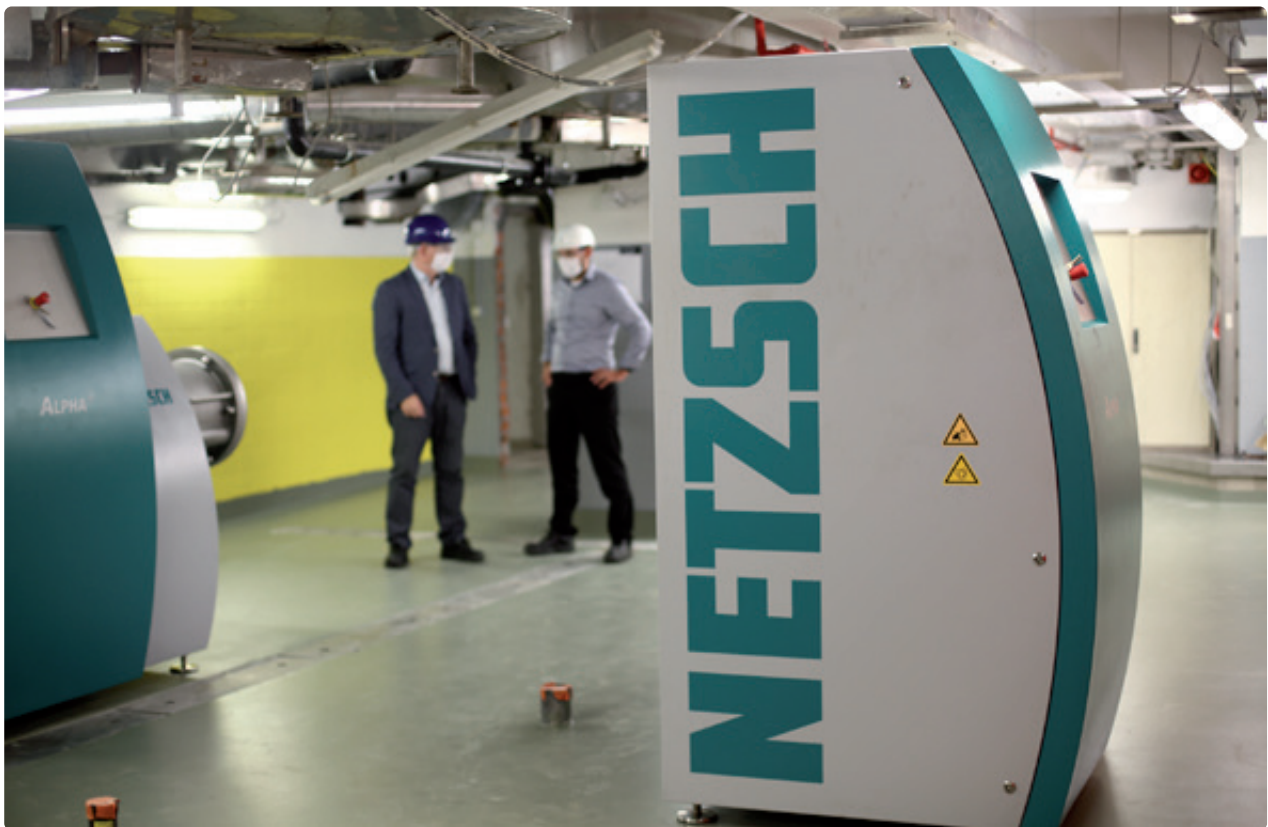
Half augustus werden de parelmolens geplaatst waarin de pigmentdispersie gemaakt wordt die de basis vormt van Agfa's inkten.
