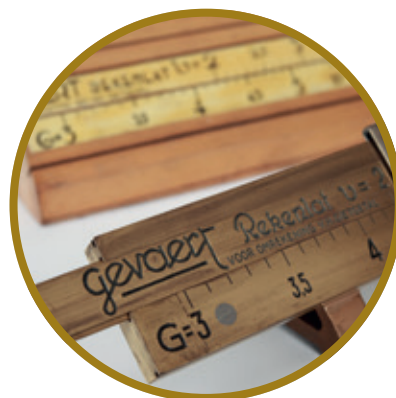
G staat voor gietgetal. Het geeft aan hoeveel m 2 er met een liter emulsie gegoten werd. V staat voor de gietsnelheid in m/minuut.
