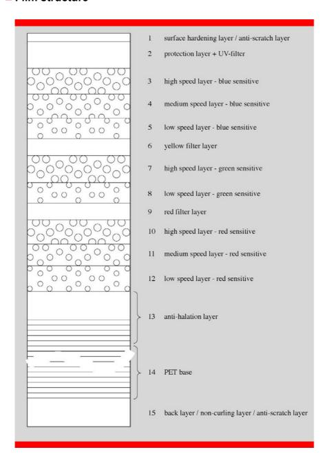
Layers 1 - 13: 22 μm PET base (14): 100 μm Back layer (15): 6μm
